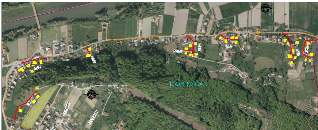
Slika 1: predvidene ureditve javne kanalizacije (rdeče – predvideno, ostalo – obstoječe)
